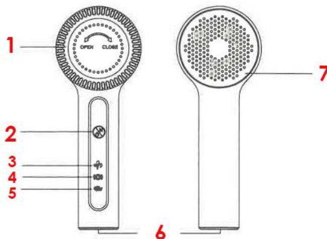
1. Red protectora del colector de pelusas, 2. Botón interruptor de encendido / cambio de marcha, 3. Icono de la 3ra marcha, 4. Icono de la 2da marcha, 5. Icono de la 1ra marcha, 6. Puerto de carga, 7. Superficie de contacto con la ropa.
